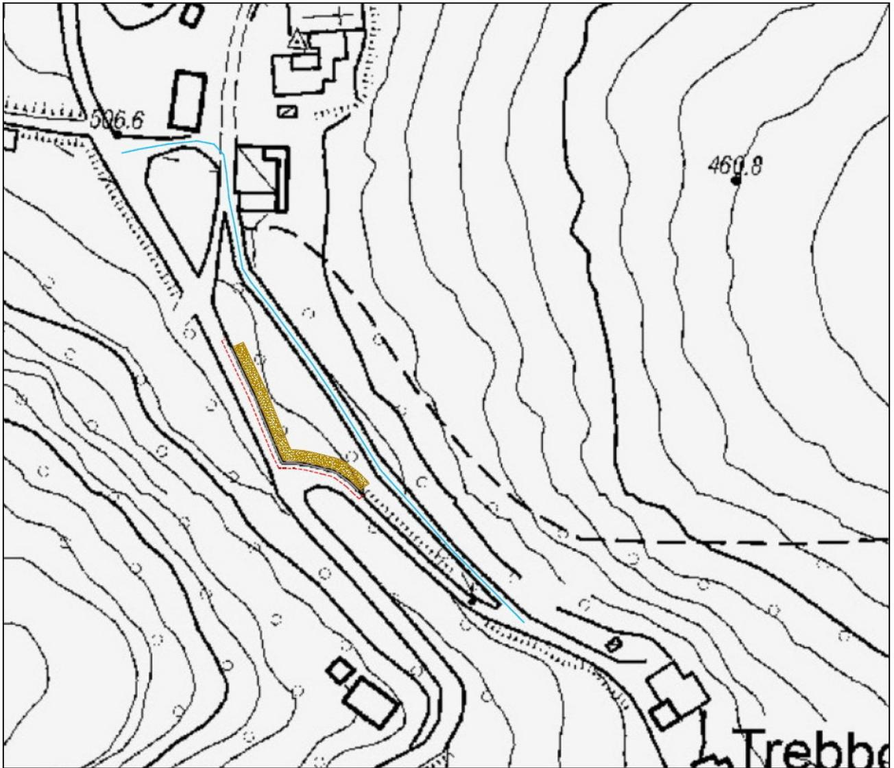
Figura 32: pista di cantiere, recinzione e viabilità alternativa
