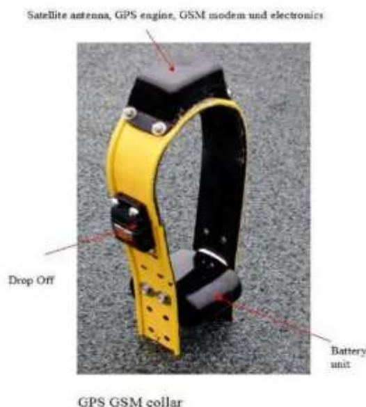
Figura 4. Il collare GPS/GSM Pro-Light4 (Vectronic Aerospace®)
