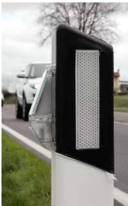
1.7.2-F5 Il dissuasore elettronico (acustico-visivo) utilizzato a Piacenza e Reggio Emilia. A sinistra posizionato su margine stradale; a destra si notano il pannello solare (A), il led luminoso in funzione (B) e il microfono (C).
